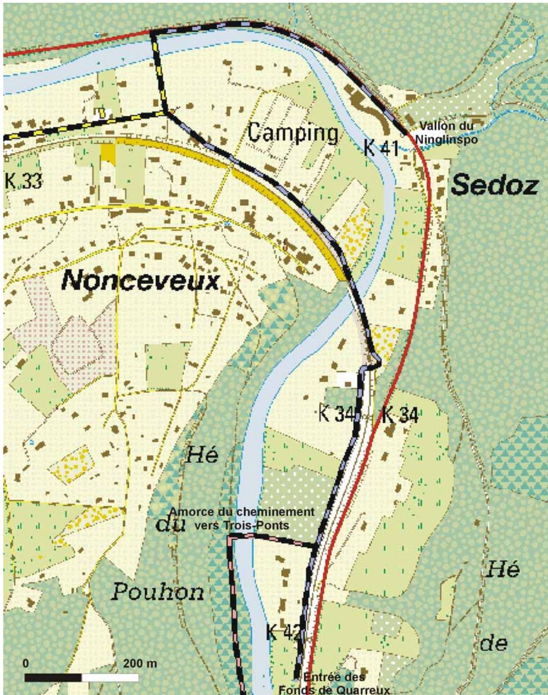
La possibilité de réaliser une bifurcation en T après avoir franchi le pont du chemin de fer ne semble pas optimale car elle nécessite des remblais ou un système de rampe afin de descendre au niveau de la berge ainsi que sous le pont et l'espace disponible paraît insuffisant au vu des habitations sises à cet endroit.
